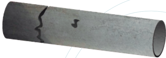
Fissure, casse ou paroi du tuyau détérioré
