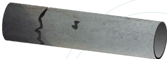
Crepe, rotture o parete deteriorata
